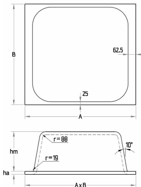
**Montagem:** A montagem dos Moldes FG requer especial atenção às juntas entre moldes e entre moldes e restantes elementos de cofragem de forma a evitar irregularidades na betonagem, devendo os moldes ficar firmemente apertados. A superfície do moldes sendo bastante regular não evita a utilização de um óleo descofrante previamente á betonagem.
