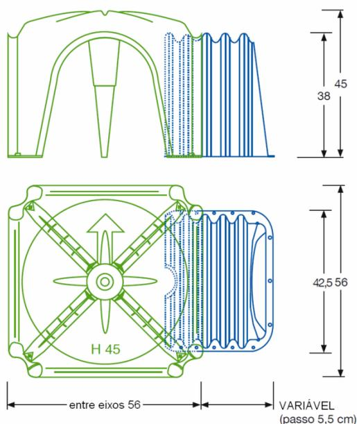
**Montagem:** As unidades Beton Stop devem ser montadas em simultâneo com as peças periféricas do sistema Cupolex de forma a ajustar a sua posição final em função da geometria local.
